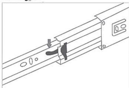
**2** Prender com a ferragem A a parte externa das correções nas laterais do móvel.
