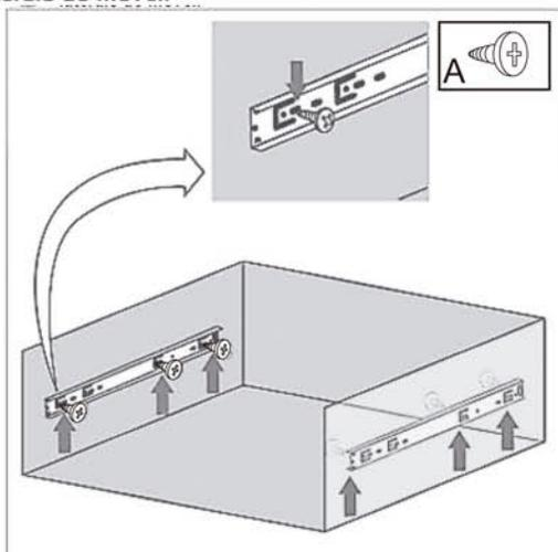
Prender a parte externa da correção no módulo utilizando somente a **ferragem A** em módulos com laterais de 18mm e utilizando as **ferragens A e C** em módulos com laterais de 15mm.
