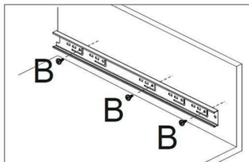
**Obs:** após a fixação da corrediça, encaixar a peça aramada na corrediça.
