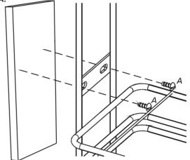
Prender a parte externa das corrediças no módulo com a ferragem A .
