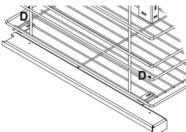
5. Conecte a tulha na porta do móvel com o parafuso (F), observando o alinhamento do mesmo no móvel. Utilize os furos oblongos para regulagem da porta.
