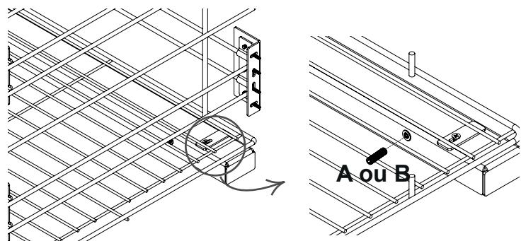
O furo oblongo possibilita o ajuste para as laterais de 15 e 18mm.
