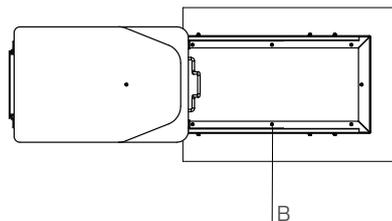
2. Prenda com o parafuso (C) a chapa que faz parte da trava da tábua (D), que é presa na base do móvel. Para determinar o local da fixação da chapa deve-se dar fim de curso na corredeira e encostar a chapa no arame. Após preso teste o trave e destrave, e encontre um meio termo para que não seja tão fácil nem tão difícil de destravar.
