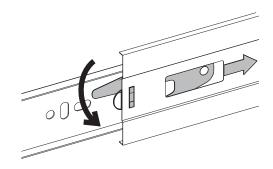
Prenda a parte externa da corrediça na lateral do módulo seguindo as marcações feitas no passo anterior utilizando a ferragem "A".
