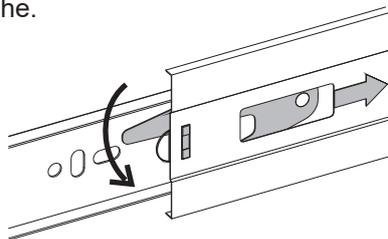
**4** Prender a parte interna da corredeira no aramado utilizando as ferragens G e B.
