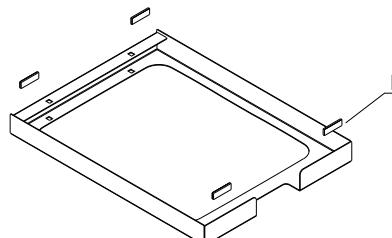
6. Encaixe a chapa superior no aramado. Após, insira o mecanismo de rolamento (H) no local indicado e fixe-o com o parafuso (G).
