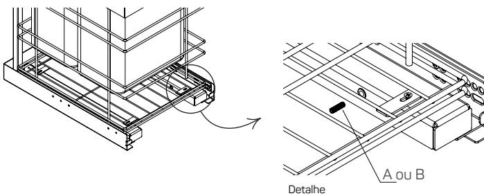
**IMPORTANTE:** Após o contato do parafuso com a corrediça, realize um aperto de 180° (meia volta). A aplicação do rosqueamento adicional expõe o mecanismo ao risco de danos que podem comprometer seu funcionamento.
