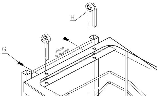
7. Em seguida, encaixe a tampa plástica no arame de suporte e realize o ajuste de altura do mecanismo de rolamento (H). Por fim, coloque os baldes.
