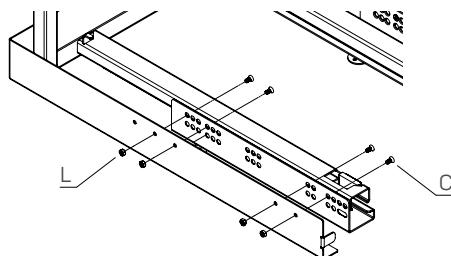
2. Fixe o carrinho na base do módulo com o parafuso (F). Após a fixação da base, realize a colagem de meio E.V.A. (I) na parte interna da aba, conforme indicação do desenho abaixo:
