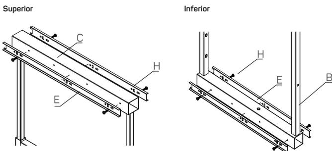
4. Para fazer o ajuste de altura do montante extensor (C) coloque o parafuso (I) no montante (B), conforme indicado na imagem. Use a chave (J) e faça o aperto final depois de prender no móvel.
