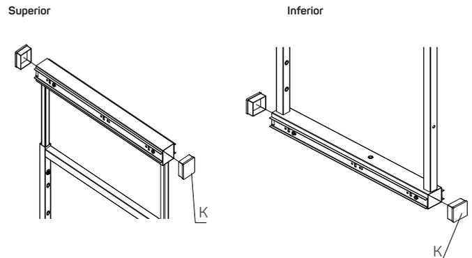
6. Monte os carrinhos dentro do móvel centralizando pelas laterais e mantendo distancia de 1cm da frente do móvel.
