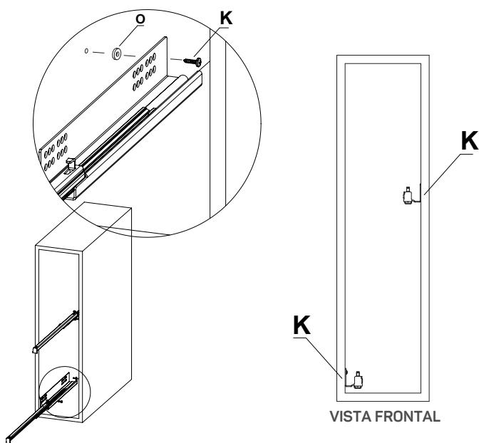
**7.** Com as corrediças instaladas, coloque a estrutura da coluna sobre as corrediças, alinhe com a frente da bandeja e faça o aperto dos parafusos conforme as instruções do passo 5
