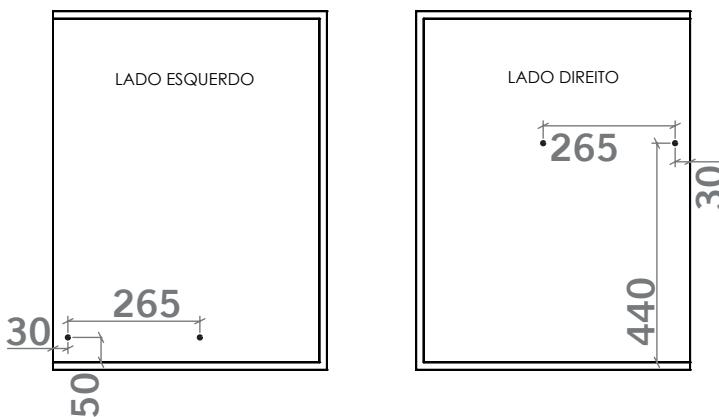
**6.** Após realizar as marcações, fixe o trilho da corrediça no módulo, utilizando a ferragem **K**. Para caixa de 15mm, utilizar a ferragem **O**.
