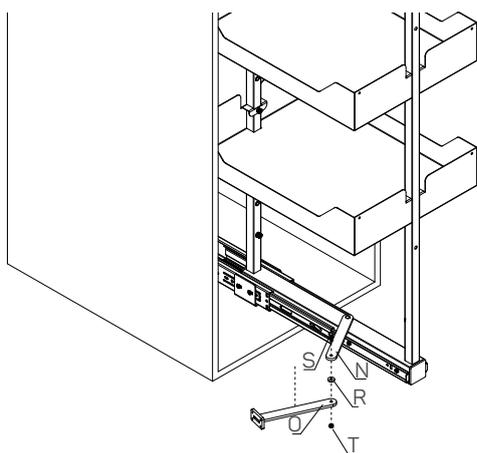
11. Fixe o braço da articulação (O) na porta do móvel usando a ferragem (U). Posicione na porta conforme as cotas apresentadas no desenho. **Obs:** a medida de Z é o valor que a porta sobrepõe o móvel.
