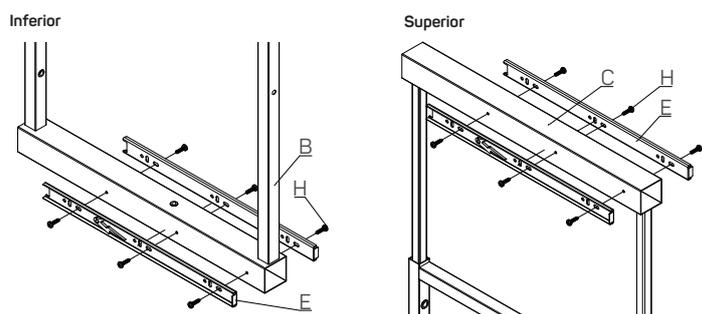
4. Para fazer o ajuste de altura do montante extensor (C) coloque o parafuso (I) no montante conforme indicado na imagem. Use a chave (J) e faça o aperto final depois de prender no móvel.
