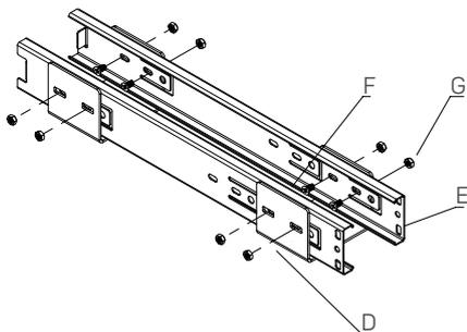
3. Fixe a parte interna da corrediça no montante (B) utilizando a ferragem (H). Faça isso na parte inferior e superior do montante, conforme imagens abaixo:
